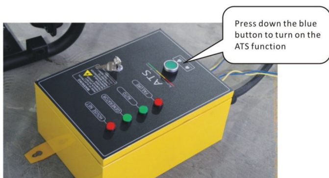
2.3. Apasati butonul albastru pentru a porni / activa functia ATS.
