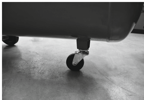
Cu ajutorul piuliței și șaiabelor montați roata din față
